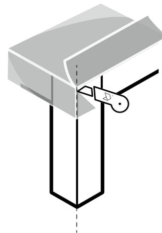
**3** **Doble** una de las dos partes sobrantes de la textura adhesiva hacia el interior y **córtela** a lo largo de la arista con el cutter.
