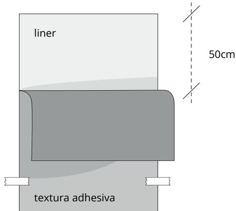
**3** Asegúrese de que el panel está **alineado con las marcas** y utilice el nivelador para confirmar que está 100% en la vertical.
